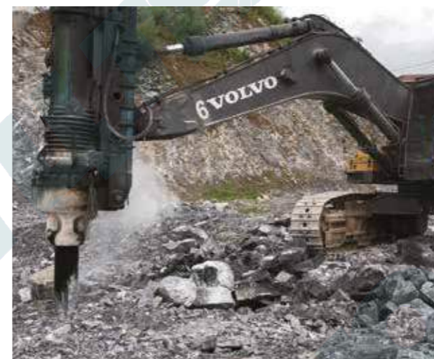
▲ Шахтный молот ZC50 с короткой мачтой на строительных работах в провинции Хунань
