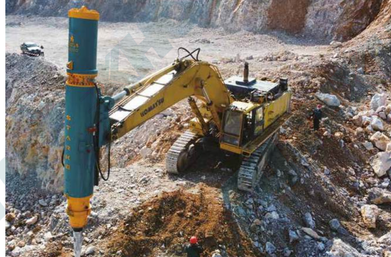
▲ HHR100 с экскаватором Komatsu PC750
