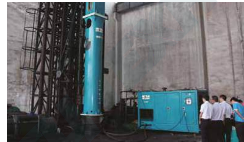
● Платформа для испытания молотов малого и среднего размеров
