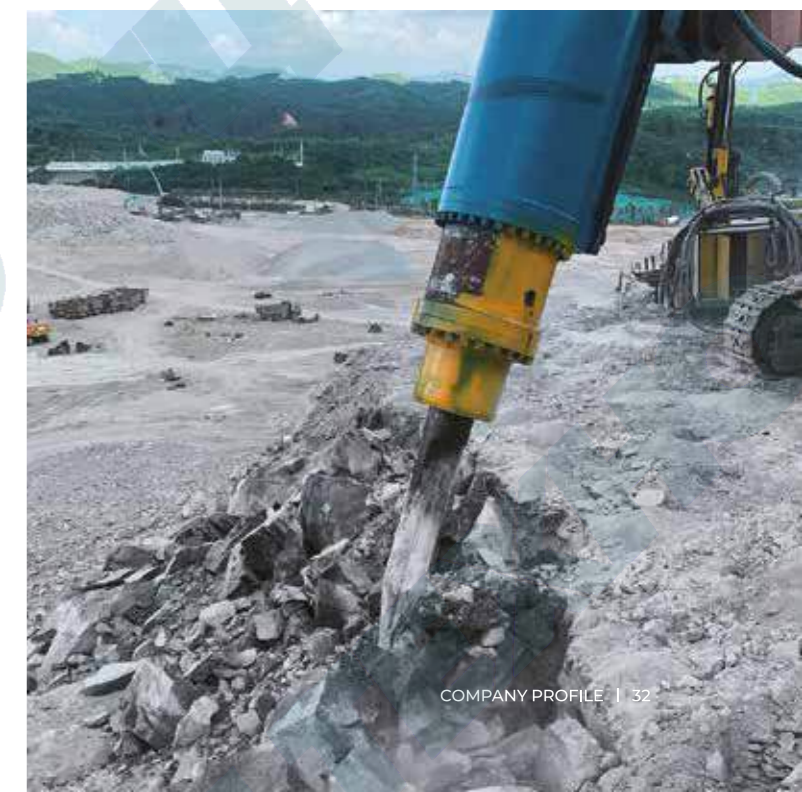
НHR100 непосредственно разрабатывает крупные камни
